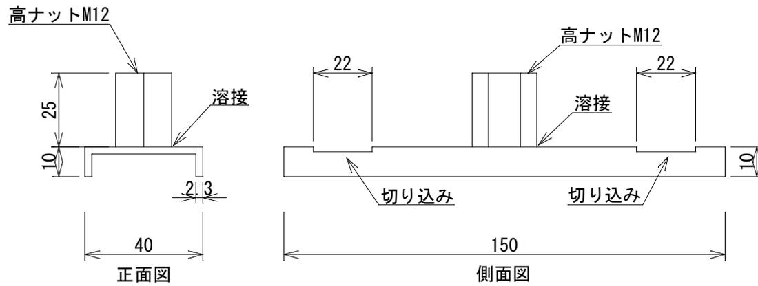
沈下棒測定ベース標準図
