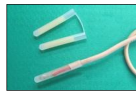
●市販の接着剤入りの、電線の端末の絶縁キャップを用いた熱電対の端部処理の例
