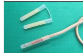
●口元を融着テープで絶縁 ●市販の接着剤入りの、電線の末端の絶縁キャップを用いた熱電対の端部処理の例
