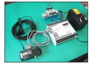
●FOMAパケット通信による河川の水位・水温・雨量の遠隔計測システムの例
