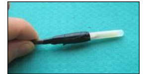
●口元を融着テープで絶縁 ●市販の接着剤入りの、電線の末端の絶縁キャップを用いた熱電対の端部処理の例
