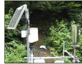
●太陽電池で動く気象観測システム
