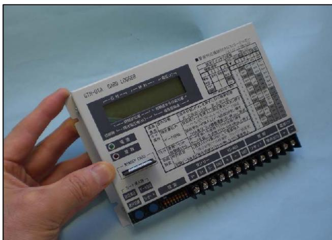
DC12V（ソーラ、バッテリー、車載）駆動可能な省電力型の1チャンネルデータロガー。
