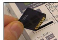
定時データ計測以外に、警報判定機能や警報接点出力、RS-485通信ポートを備え、遠隔監視や防災警報装置として使用できる。
