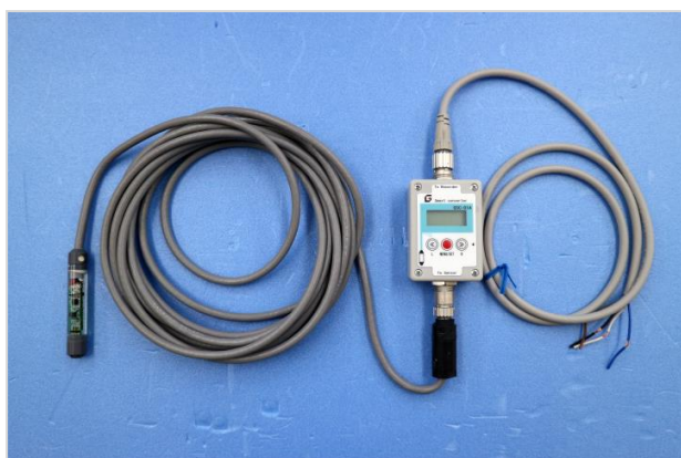
温湿度センサ部 変換部(気圧計内臓) 出力ケーブル
