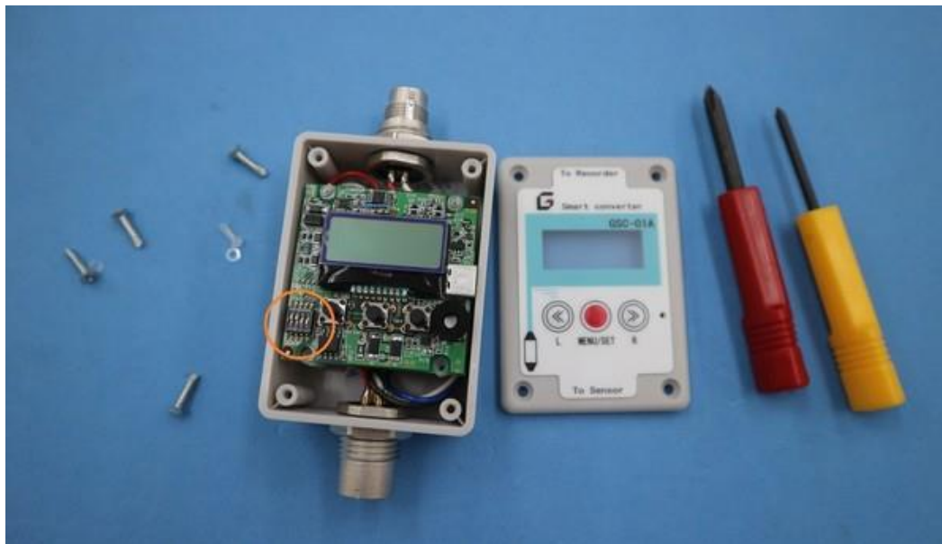
図-10 湿度計 GHT-01A のアナログ出力電圧を変えるディップスイッチの場所
