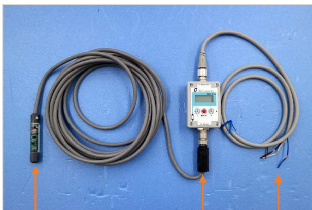
温湿度センサ部 変換部(気圧計内蔵) 出力ケーブル
