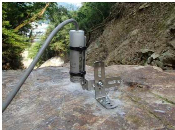
図-6 高精度 GIC-10WD のアンカー固定
