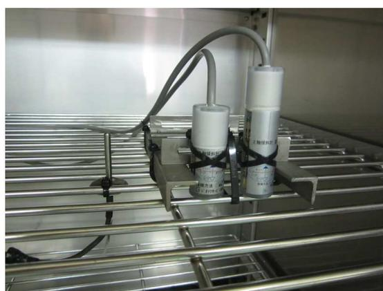
図-3 恒温槽内の傾斜計
