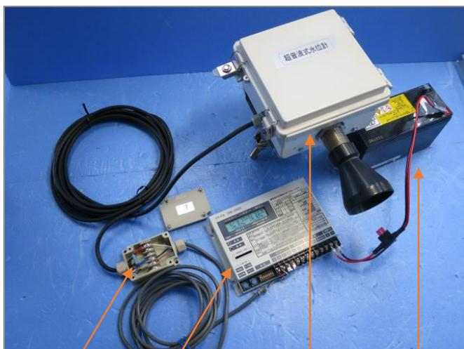
ケーブル延長ボックス データロガー 水位センサ本体 バッテリ
