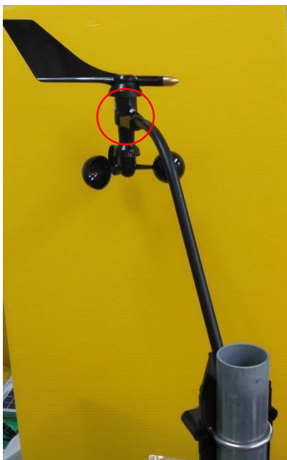
アームの取り付け位置向きを実際の方角に合わせる
