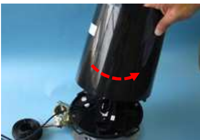
①上カバーを左回しで外す （下の台を押さえ強く回す）
