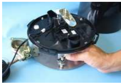
②実際に取り付けた状態で 蝶ネジ回して水平調整
