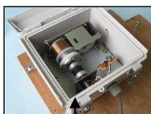
※この伸縮計は測定距離の絶対精度が±2%と低目ですが、計測値の安定性に優れているため、温度変化が大きくや風雪に曝される地すべりや土木構造物の変位計測に適します。
