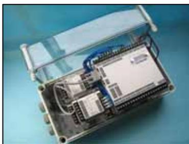
計測ボックスへの組込例(4CH 収納)
