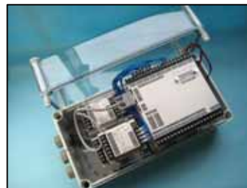
計測ボックスへの組込例(4CH 収納)
