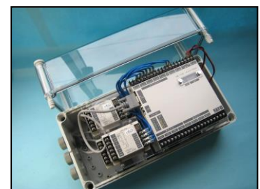
計測ボックスへの組込例(4CH 収納)
