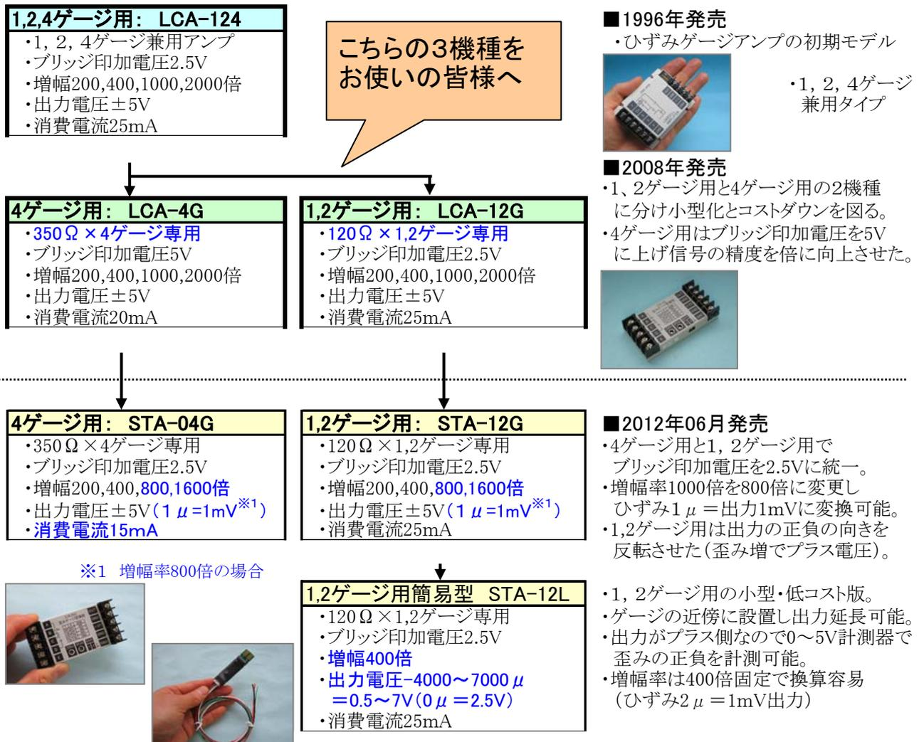
③旧製品で 2000 倍を使用→新 STA-12G で 1600 倍に設定すると、出力は 2 割減（例：5V→4V）。
