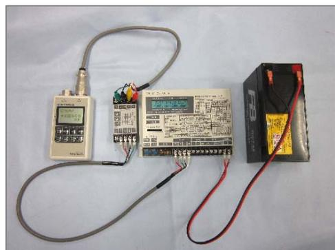
写真2 ひずみアンプとロガーの接続例
