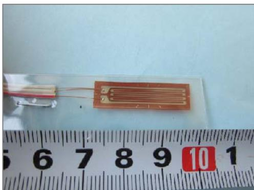
写真1 120Ω 3線式のひずみゲージ例
