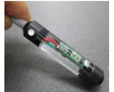
圧力センサ部 変換部(気圧計内臓) 出力ケーブル (写真は1m計+10mケーブル付きです。変換部は防滴構造)
