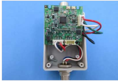
図-12 初期ロット限定のRS-485 切替方法
