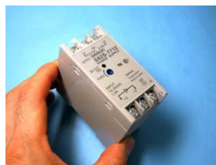
②市販の 24V/12V 変換器 OMRON S82S-7312 (3W)
