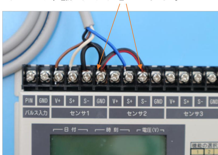
図-7 信号線のマイナス側の扱い—電源 GMD と共通
