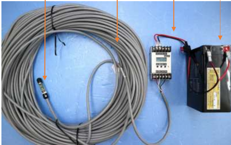
図-1 水位計の構成
