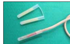
口元を融着テープで絶縁 市販の接着剤入りの、電線の端末の絶縁キャップを用いた熱電対の端部処理の例
