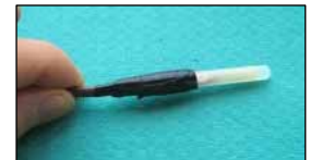
口元を融着テープで絶縁 市販の接着剤入りの、電線の端末の絶縁キャップを用いた熱電対の端部処理の例
