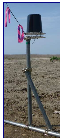
【単管パイプ設置例】
